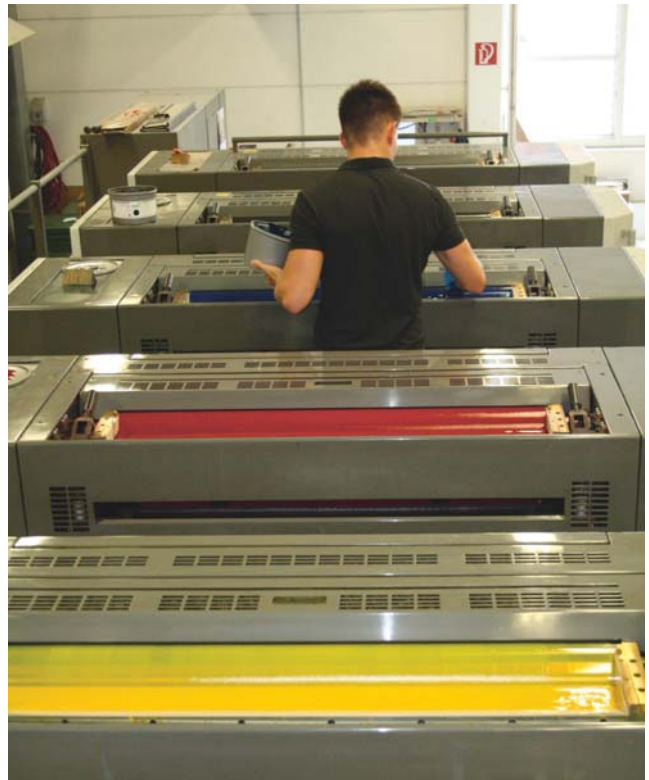
Die vier Druckwerke der Druckmaschine: Drucker Timo Böhn füllt die Farbe für den Vierfarbdruck nach.
